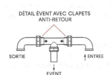
Figure F5.2.3.5 – Dispositif d'évent avec clapet anti-retour
