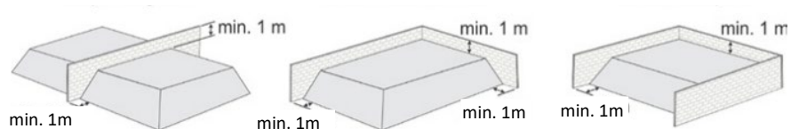
Figure F6.12.2 : Limites de dépassement des murets de séparation des alvéoles de stockage
